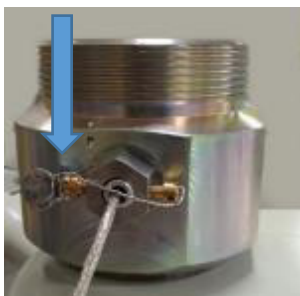
Монтаж термопреобразователя сопротивления Pt500 (500П) в потоке газа
