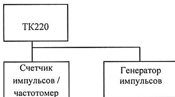
Рисунок 1 – Схема подключения генератора импульсов и частотомера
